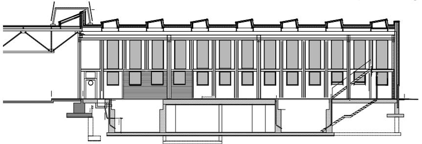
Querschnitt Halle mit Unterfluranlage
